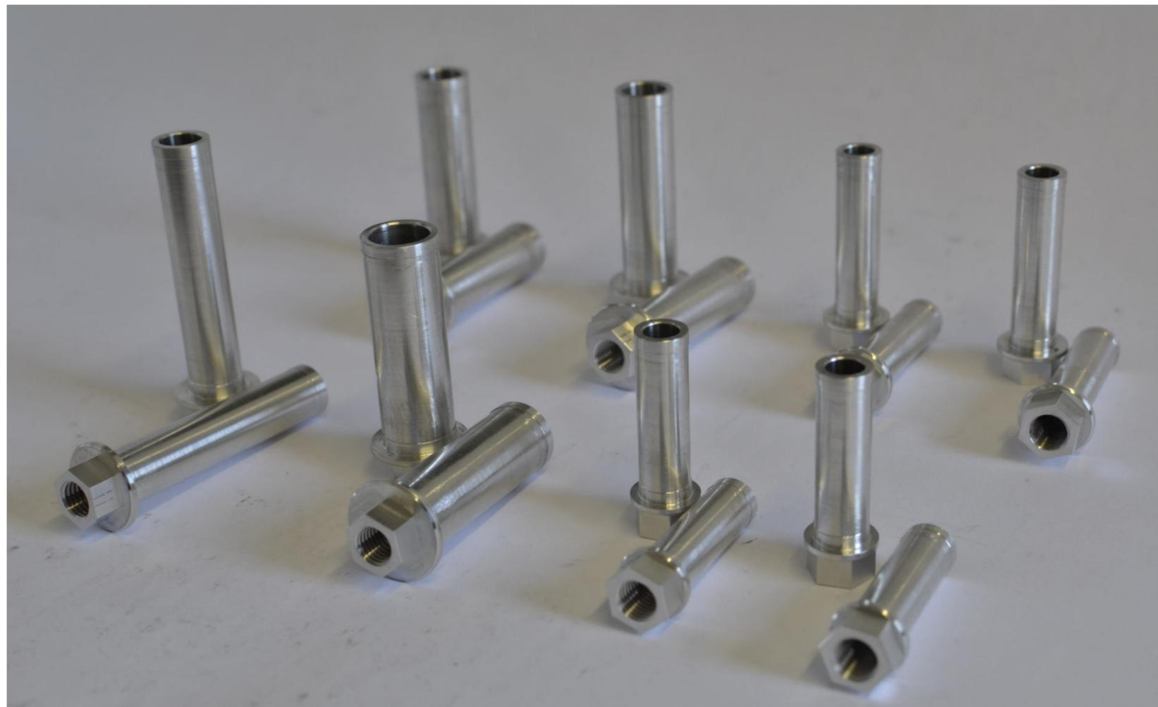
*Klebebuchsens diverser Querlenker*
