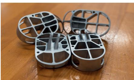
Vielen Dank an Werkzeugbau Felgner für die schnelle Fertigung einiger komplexer Fahrwerkinlays, bei welchen dieses Jahr die Querlenkeranbindung am Monocoque direkt mit integriert sind.
