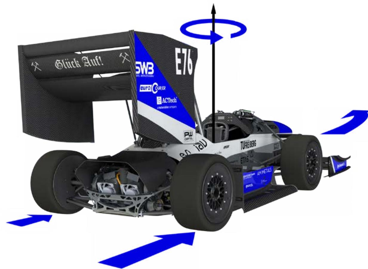
*In Kurven werden die Räder unterschiedlich stark angetrieben, um das Eindrehen um die Fahrzeughochachse zu verbessern*
