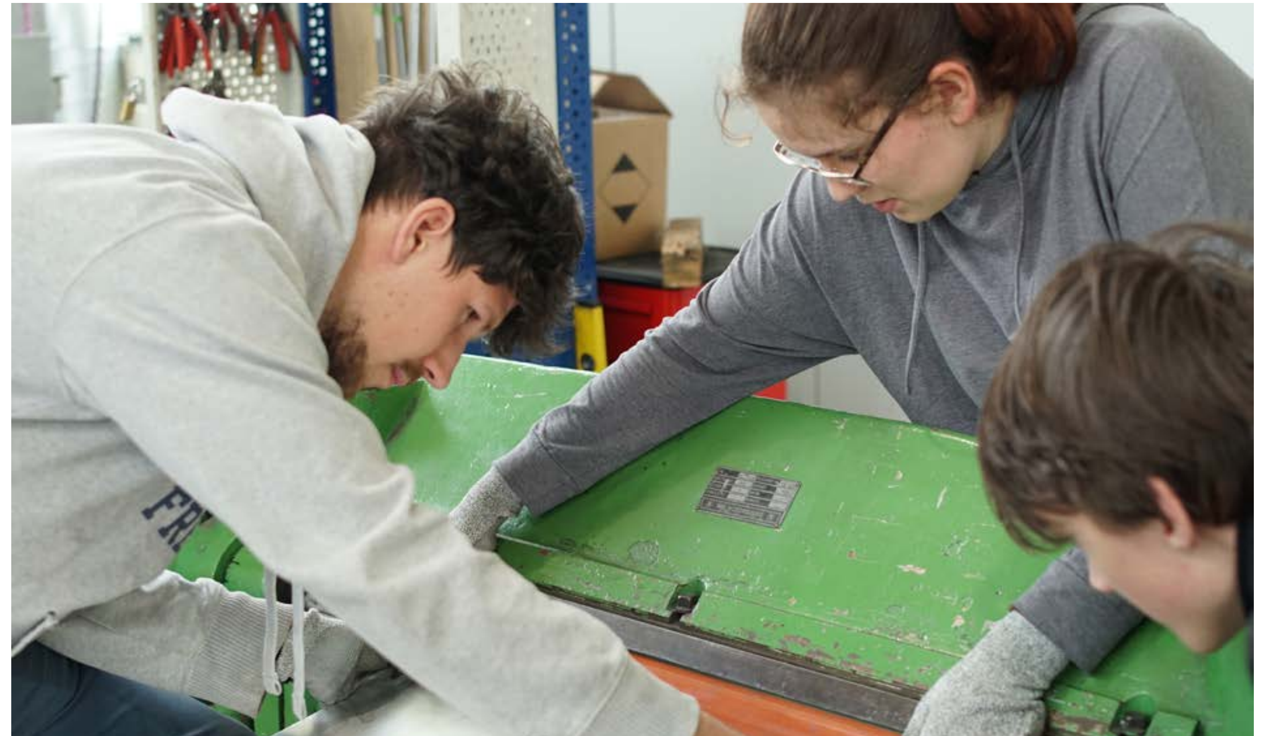
Maßgenaues Biegen der Chassis-Bleche
