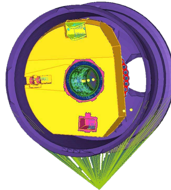
Bauraummodell des Radträgers in der Radbaugruppe
