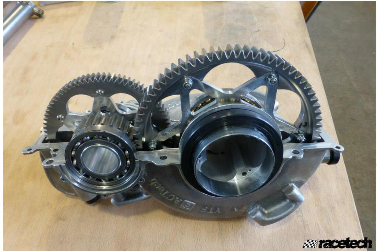
Mittel- und Ausgangswelle eingebaut im Hinterkasten des Gusshecks
