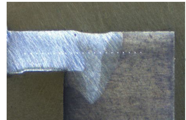
Die fertig geschweißte Welle
