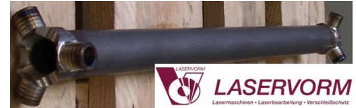
Die fertig geschweißte Welle
