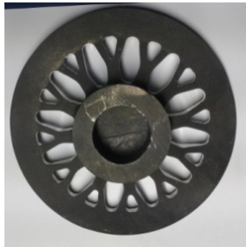
Der noch unbearbeitete Gussstern aus Magnesium
