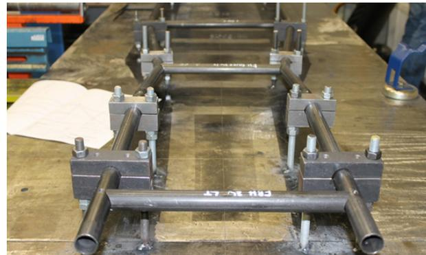
Längsträger mit eingepassten Rohren
