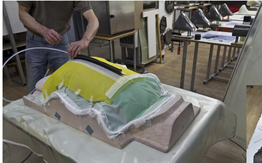
Die fertig belegte Laminierform vor und nach dem Einpacken
