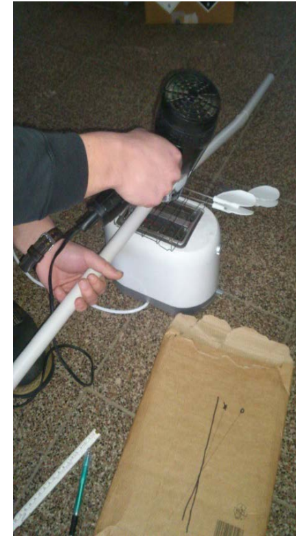
Biegen mittels Toaster und Föhn
