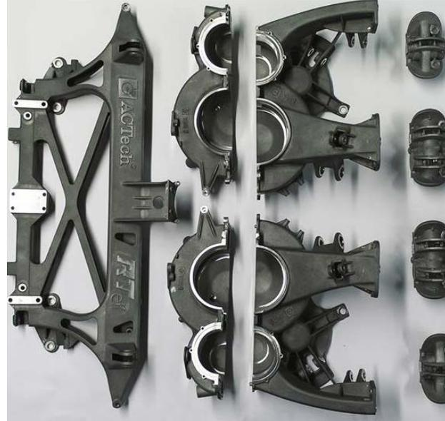
mit einem Heckrahmen oder einem Voll-Monocoque, machten die Entscheidung für uns leicht, weiterhin auf dieses Konzept zu setzen. So haben wir in Zusammenarbeit mit der AcTech GmbH dieses Jahr unser mittlerweile fünftes Gussheck entwickelt. Mit seinen über 50 Anbindungspunkten gehört es zu den kom-
