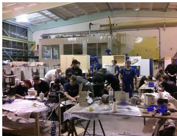
Das Team beim Schleifeinsatz Überarbeitung aufforderte. Auf die Politur der Magnesiumbleche wurde jedoch nicht verzichtet. Insbesondere großflächige Teile bekamen durch neun Schleifstufen per Hand und eine Endpolitur mittels Exzenter schleifer den spiegelnden Glanz. Am Freitagmorgen konnte dann das Beschichten
