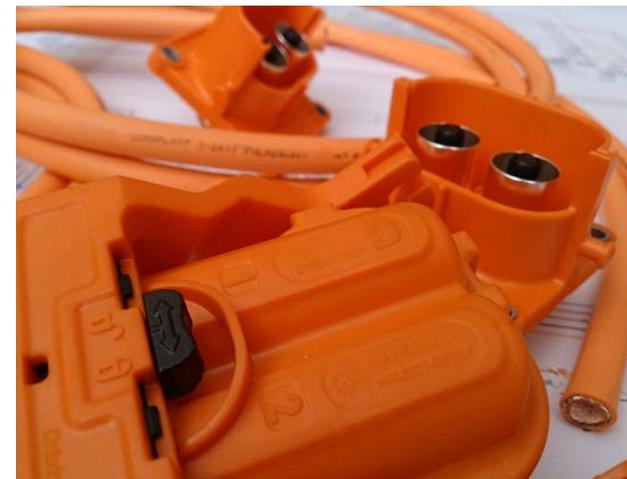
Sicherungsstifte der Hochspannungsstecker gegen das unbeabsichtigte Lösen im Betrieb
