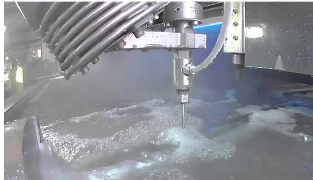
Eine Wasserstrahlschneideanlage in Betrieb
