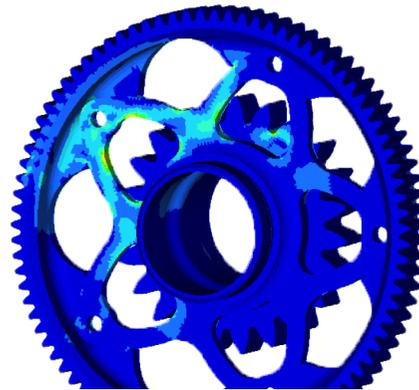
Spannungsanalyse des Getriebes
