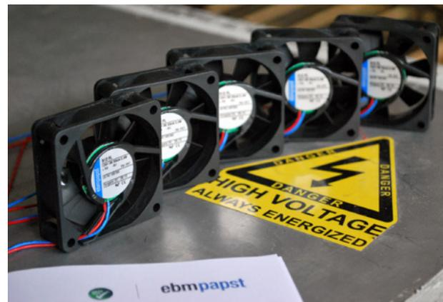
50mm-Axiallüftern auch leistungsstarke 80mm-Axiallüfter, welche sich dank Pulsweitenmodulation intelligent regeln lassen. Die Lüfter zeichnen sich durch einen energieeffizienten und geräuscharmen Betrieb, ihre kompakte Bauweise und eine hohe Zuverlässigkeit aus und passen somit perfekt in unsere Zielstellung, mit dem RTo7 einen effizienten und erfolgsversprechenden Elektrorennwagen zu bauen.
